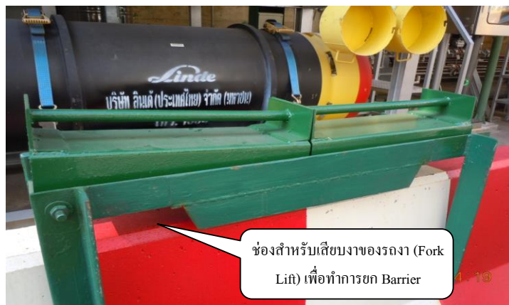
รูปที่ 1 Barrier และ Jig ที่ใช้ในการช่วยยก Barrier
